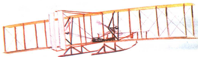
莱特兄弟创造出他们自己的飞机——飞行者1号。他们俯卧在飞机上驾机飞行
