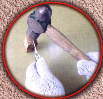
1. 用电工刀切削木塞。
