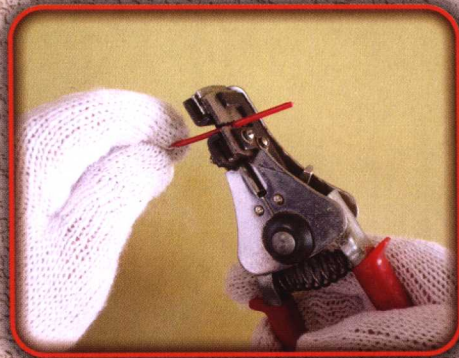
2. 根据电线粗细，选择合适的剥线钳口，把电线头放入剥线钳。
