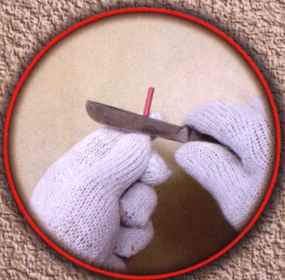
3. 用电工刀按 45^\circ 剥较粗电线
