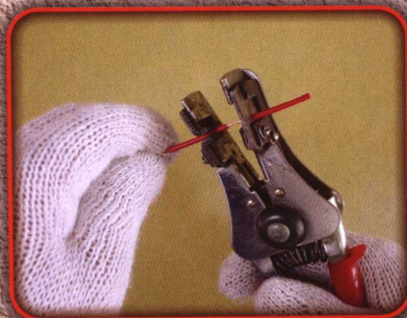
3. 右手压下剥线钳把，剥掉绝缘层。
