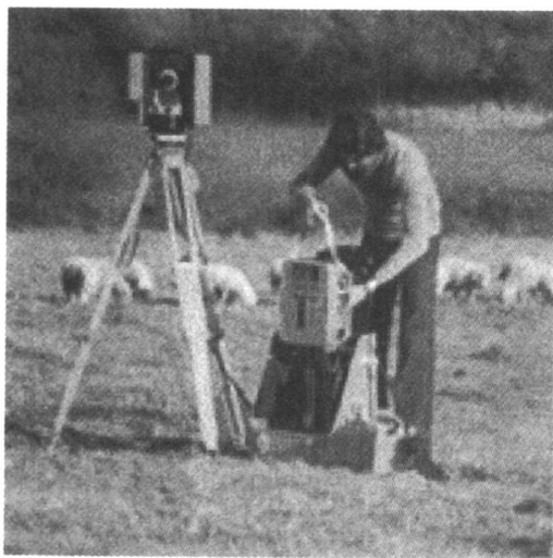
图 1-4 在 1970 年初,正弦波式测距仪已经替代了军用工程领域中的经纬仪,它能直接测量几百米的距离,它有厘米数量级的分辨率
