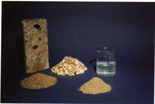
图 1.1 混凝土组分:水泥、水、细集料和粗集料
