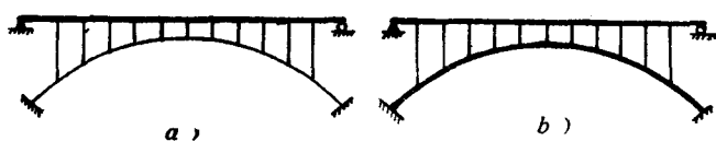
图4-1-7 有推力的组合体系拱 a)倒蓝格尔拱；b)倒洛泽拱
