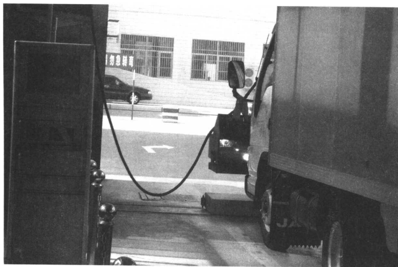
在机动车安全检测线上,对机动车的灯光亮度进行检测
