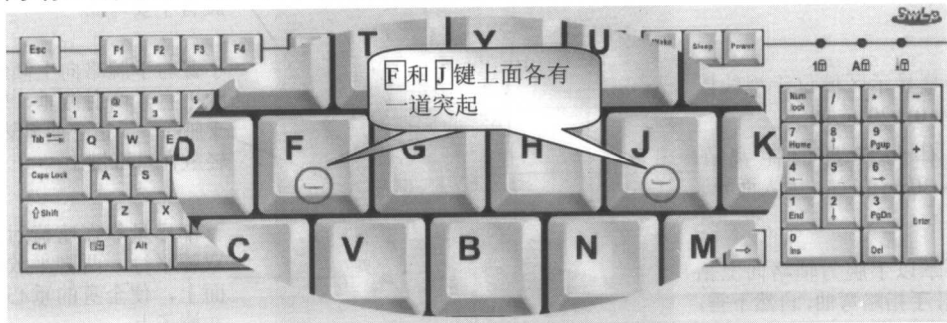
图 1-10 键盘的 F 和 J 键上面各有一道突起
