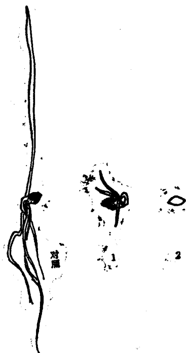
图 6 某厂磷肥对小麦幼苗的抑制 对照：无毒磷肥(1克溶于100毫升水) 1. 某厂磷肥(1克溶于100毫升水) 2. 某厂磷肥(10克溶于100毫升水)
