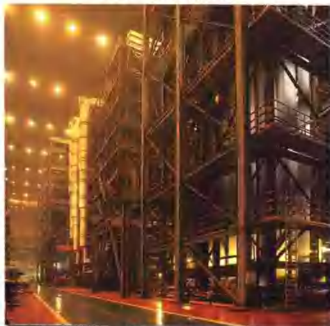
宝钢生产的热镀锌钢板以其优良的品质广泛用于汽车、家电、建筑等领域。图为三期新建成的1550热镀锌机组。
