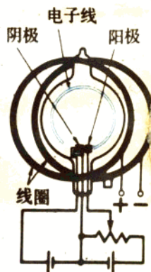
图2 电子射线在磁场作用下弯成圆形
