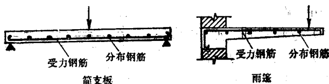
图 1-10 分布钢筋在构件中的位置
