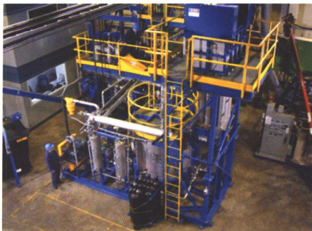
图7 Dynamotive's生物 物质流化床快速热 解设备（加拿大）
