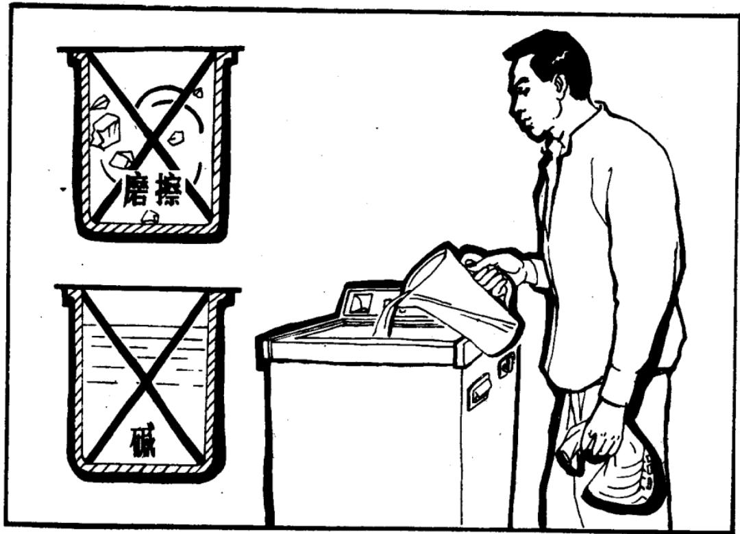
11 铝质洗涤桶的表面经过氧化处理，有一定的耐腐蚀能力，但耐碱、耐磨性能不如搪瓷桶。铝质洗衣桶成型容易，不会生锈，能满足实际使用要求。目前已为多数洗衣机所采用。
