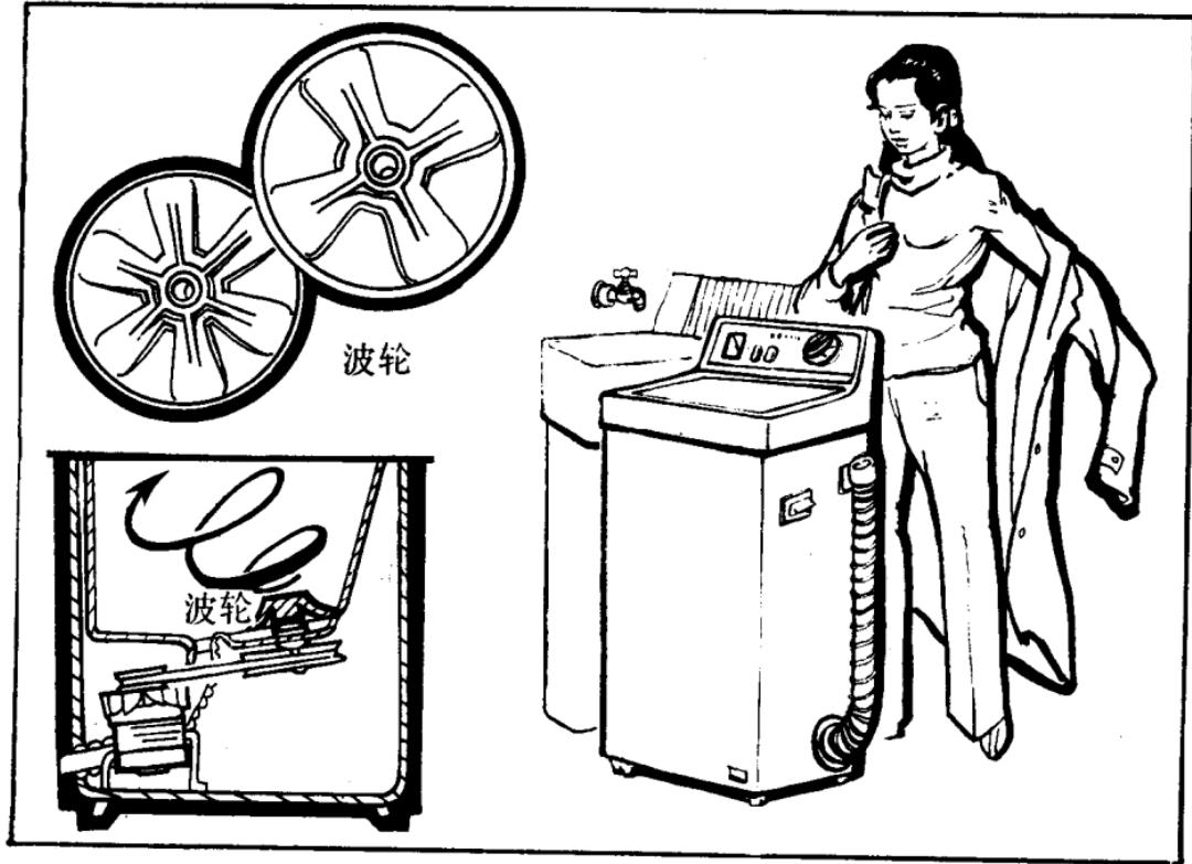
5 波轮式洗衣机的容器是个立桶，称“洗涤桶”。偏离桶底中心处，装有一只塑料圆盘，圆盘上有4~6条凸筋，称为“波轮”。波轮在电机带动下旋转，使洗涤物在洗涤液中相互磨擦，从而代替人工的搓洗。
