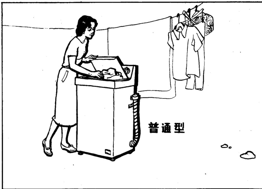
7 半自动洗衣机，它由洗涤和脱水两部分组成。将洗涤物先放在洗涤桶内完成洗涤和漂洗后。然后由人工把洗涤物从洗涤桶内取出放入脱水桶中进行脱水。再把衣物取出直接晾晒。
