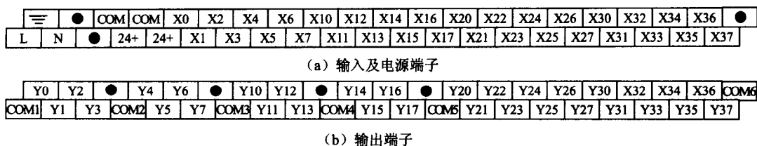
图 1-9 FX 2N -64MR 接线端子图
