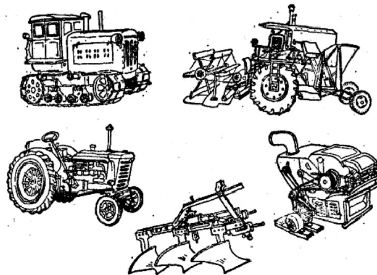
这些机器的本领可大了。一辆大型拖拉机挂上两架五铧犁，两三个人一天就能耕地四百五十亩。如果用人工耕地，就要用一百五十个人、一百五十头牛、一百五十副犁，一天才能耕四百五十亩地。联合收割机的本领就更大了，它可以收割、脱粒、搬运、清选、装车，一次完成。它可以顶得上三四百人干活，而且收割得又快又干净。
