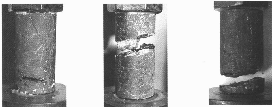
图4 直接单轴拉伸实验时煤样实际破坏状态
