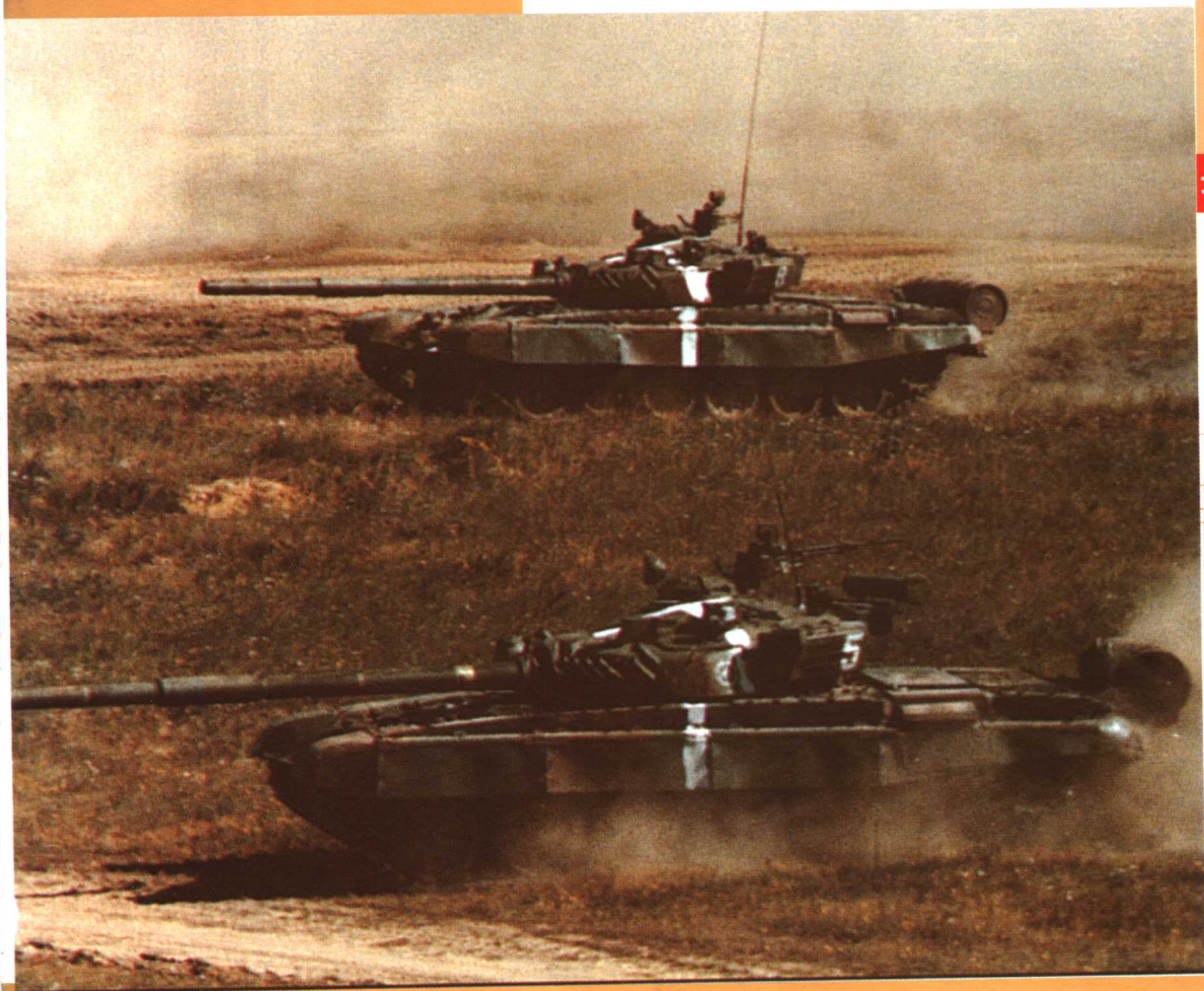
演习中的T-72型坦克。该型坦克装备了专为125毫米口径主炮设计的自动装填系统。
