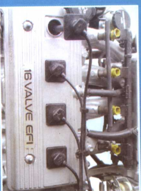
图2-6 按下分缸高压线
