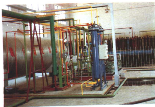
从英国引进的先进的高纯度 \text{CO}_2 回收装置
