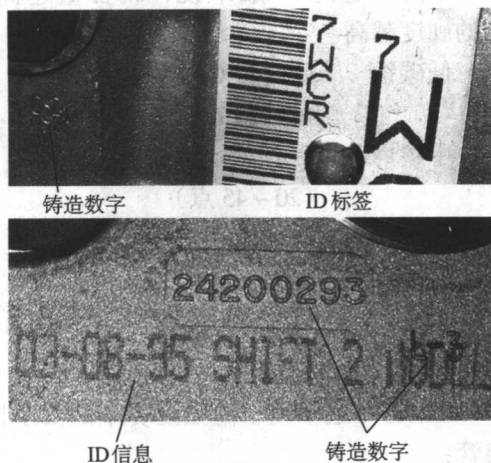
图 1—4 铸造有数字的两个变速器壳，同时可见 ID 标签或打印的 ID 信息
