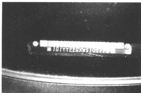
图1—1 VIN汽车识别码在仪表板前方顶部,透过挡风玻璃可见
