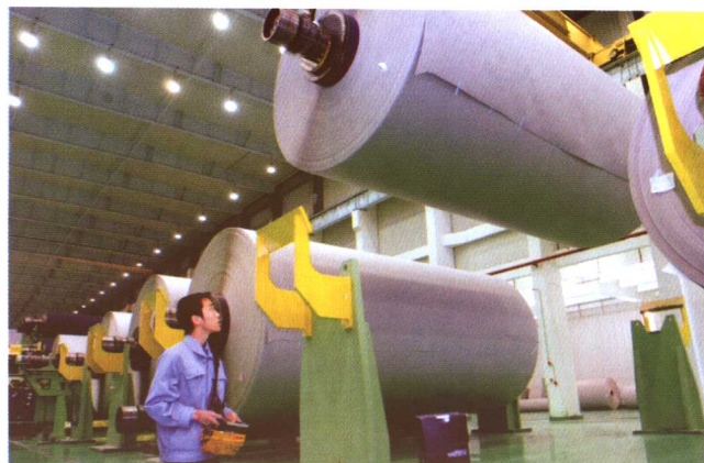
2004年12月24日，浙江省宁波市金光集团宁波中华纸业三期工程投产。这条生产线总投资118.3亿元，年产可达75万吨，采取球型煤场和深海排放污水等高科技技术，日处理污水4万吨，水资源重复利用达到50%；吨纸耗水降低到行业标准的六分之一，回收废纸占所用纸浆原料85%以上，掀开了中国“绿色造纸”的序幕。图为工人在工业板纸生产线上控制成品吊车。
