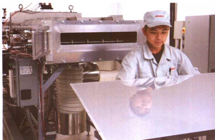
2004年7月一条年产5兆瓦柔性衬底非晶硅薄膜太阳能电池的示范生产线在天津建成投产。这条生产线是目前中国境内生产规模最大、也是唯一可制造双结非晶硅太阳能电池的生产线。它的建成投产，使中国非晶硅薄膜太阳能电池初步实现产业化生产。非晶硅薄膜太阳能电池具有低成本、高产率、使用寿命长的特点。图为天津市津能电池科技有限公司员工在完成非晶硅薄膜太阳能电池的溅射工艺。
