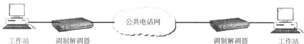
图 1-7 通信系统实例
