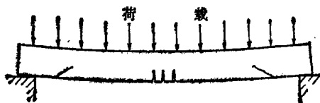
图 1-1 混凝土梁受力破坏图
