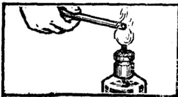
向推，不能象拉锯来回锉。然后，按上图中所示，双手握在刻痕的两侧，在拇指向外用力扳动的同时，双手略向两头拉，玻璃管即被切断。最后，将断口放在酒精灯的火焰上烧烤，并不断转动。待发红时取出，冷却，管口就变平滑，不致划破手指或划破胶皮管及单孔橡皮塞的孔等。这一步叫管口“熔平”。
