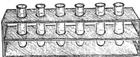
选择鞋盒时，注意敞口的宽度应小于试管的高度。如果没有尺寸合适的鞋盒，也可以用硬纸板糊一个。有条件的话，再在纸盒内外涂一层漆，就能延长使用寿命，还便于揩擦，保持清洁。
