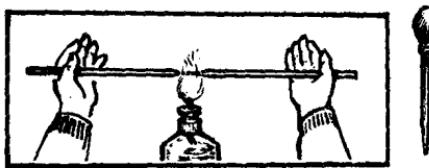
当蓝火苗变成鲜桔红色时，先将玻璃管从两头向里挤，使管壁变厚。再移开火苗，向两头拉伸，管子就会产生缩颈。冷却后，用切割玻璃管的方法将它切
