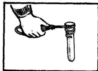
变大一点。圈的大小以能自由套进试管，又不太松为合适，让试管口正好卡在铁丝圈上。最后，将铁丝另一端变成长扁形环状，作为把手。做这样3—5个不同尺寸的把手备用。
