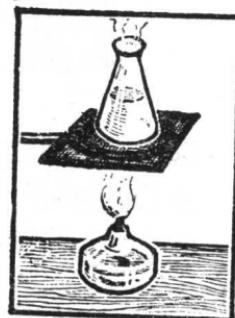
网垫做成后，使用时把它放在环托（制做方法后面介绍）上，上边放加热容器，下面放热源（如酒精灯等）。这时就可以进行化学实验加热了。
