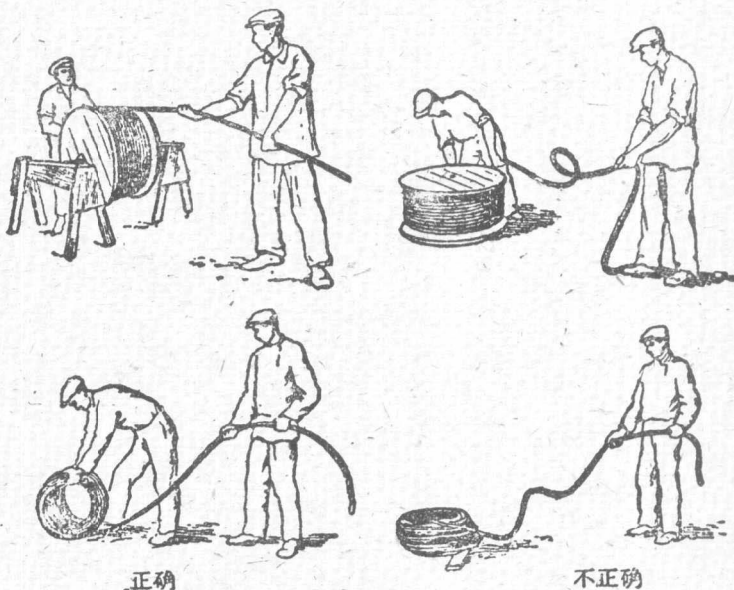
图 1-5 打开钢丝绳卷的方法
