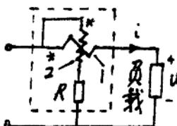
电动式功率表(简称瓦计)测负载功率时的接线如图,虚框内表示瓦计,水平画出的波折线表示固定线圈 1。垂直画出的波折线表示可动线圈 2。固定线圈与负载串联,负载电流全部通过固定线圈,所以又把它叫电流线圈。可动线圈与附加电阻  $R$  串联后与负载并联,可动线圈与附加电阻一起承受整个负载电压  $U$ 。所以可动线圈又叫电压线圈。
