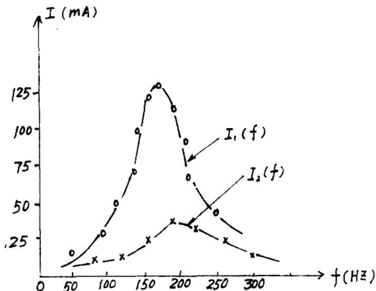
RLL 串联电路谐振曲线
