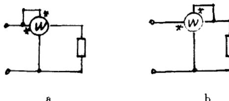
(a) 为前接法，电流线圈的电流与负载电流相等。电压线圈承受的电压应包括电流线圈两端的电压降。所以这种接法瓦计读数应包括电流线圈的损耗在内。
