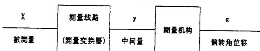
测量机构只能将电量  $I$ 、 $U$  或  $I_1 \cdot I_2$  转化成角位移指示出来,若待测量是其它量如功率,电阻等,则须加测量线路加以转换。
