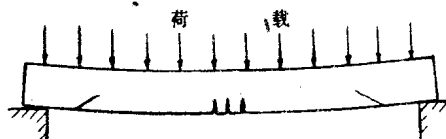
图 1-1 混凝土梁受力破坏图
