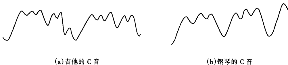
图 1-3 吉他和钢琴的音色波形
