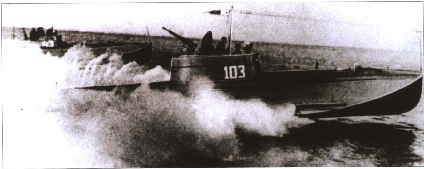
■ 二战前的苏联红海军奉行“小规模战争理论”，即隐蔽地集中相互协同作战的海军各种兵力，在不离开自己基地的条件下，从几个不同方向，对敌主要目标实施短促突击，主要精力放在建立轻型水面舰艇和潜艇兵力上。这是图波列夫设计局根据上级意图研制的快速鱼雷艇。
