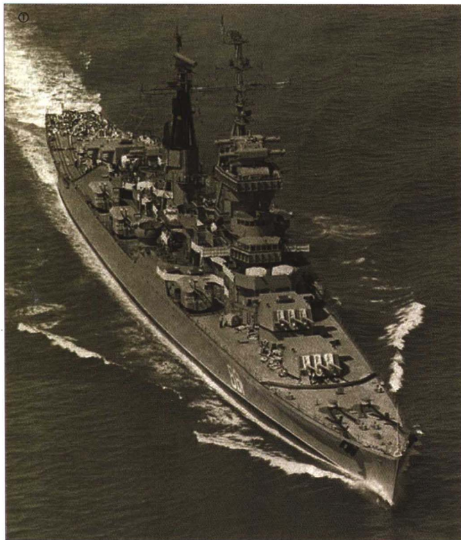
■ ① “米哈伊·库图佐夫”号巡洋舰，可清楚地看到其基本线型和甲板布置。 ② 在苏联红海军举行的联合对抗演习中，苏联维克托III级核潜艇从潜望镜中观察“米哈伊·库图佐夫”号巡洋舰的镜头。斯维尔德洛夫级是二战后建造的极少数采用三脚桅的苏联军舰，因为当时需要安装的各种雷达天线和其它电子设备还较少，可以采用这种简单的桅杆造型。
