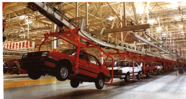
9万平方米的总装车间，全线153个车位，设计能力15万辆，全线实行电脑控制，单班生产260辆捷达轿车
