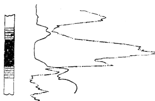
图二 人工伽玛曲线在无烟煤层中的反映
