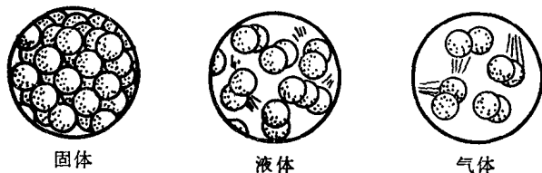
图2 碘的固体、液体和气体的分子间距离比较示意图
