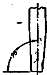
圖14 刮刀頂端跟刀身中心線成90度。
