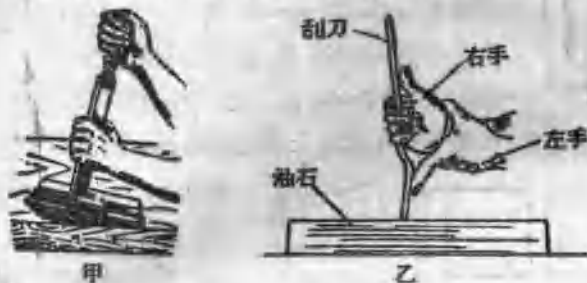
圖17 用兩隻手磨刮刀頂面。
