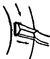
圖13 磨刮刀裏面平面情形。
