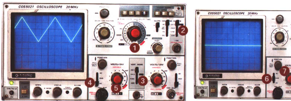
彩图 5 利用示波器校准信号发生器
