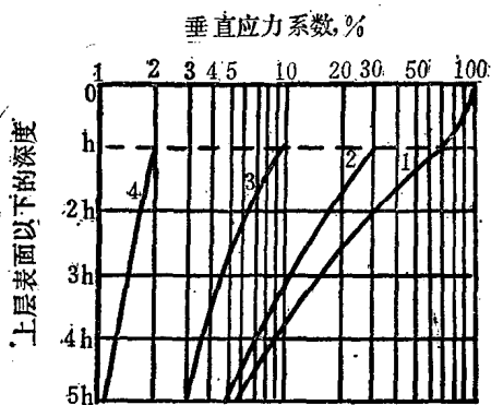
图2 圆形均布荷载作用下双层体系中垂直应力的分布情况。
