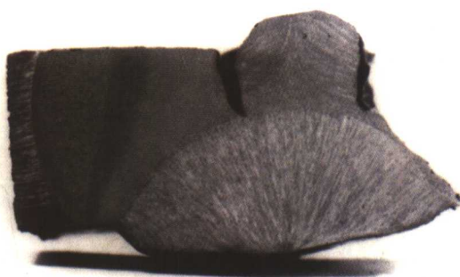
(a) 解剖所得应力腐蚀裂纹照片
