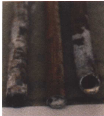
图5-4 低温过热器管结盐垢 超温爆管 (见第157页)
