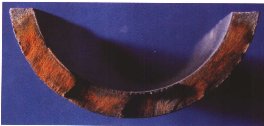
图16-14 低合金钢过热器管腐蚀疲劳脆性断口（见第502页）
