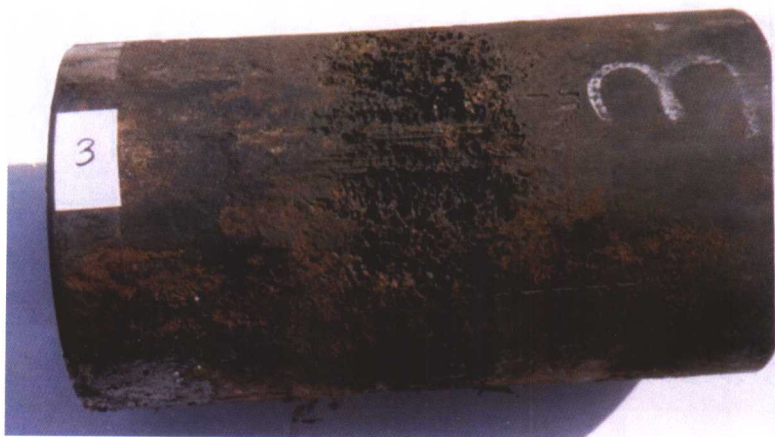
图18-40 接箍腐蚀后宏观形貌 (见第548页)
