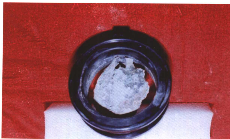
图18-45 失效阀瓣常面对海水一侧的宏观形貌（见第553页）
