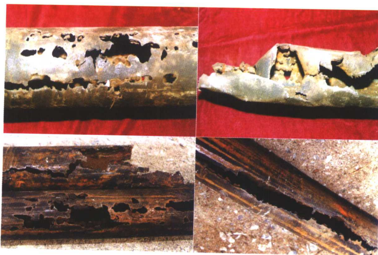
图3-14 塔里木油田某一油井油管腐蚀状况（见第81页）
