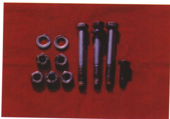
图18-20 螺杆、螺母和垫片的腐蚀形貌 (见第538页)
