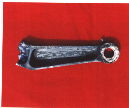
图16-33 机翼翻板支承臂的宏观形貌 （见第511页）
