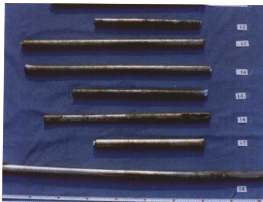
图18-17 部分管束下部腐蚀形貌 (见第536页)
