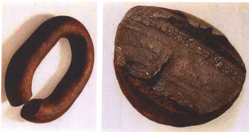
图16-13 海港挖泥船链环的腐蚀疲劳断口（见第502页）
