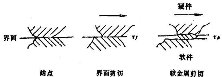
图1-6 粘着结点的剪切
