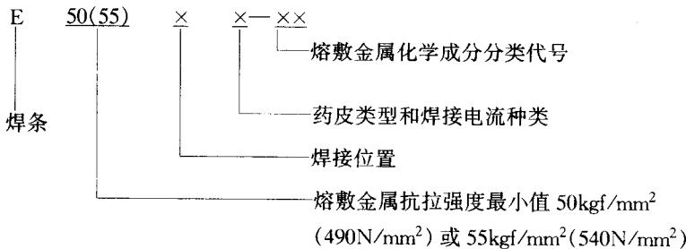
《钢结构设计规范》GB 50017—2003(本书以后有时简称《规范》)规定,手工焊接采用的焊条应符合现行标准《碳钢焊条》GB/T 5117 或《低合金钢焊条》GB/T 5118 的规定,选择的焊条型号应与焊件的金属力学性能相适应。对于一般钢结构(除重级工作制吊车梁、吊车桁架或类似结构外),对于 Q235 钢的焊件宜用 E43 系列焊条,对 Q345 钢的焊件宜用 E50 型系列焊条,对 Q390 钢、Q420 钢的焊件宜用 E55 系列焊条。
