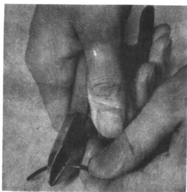
圖 1 — 4 用剪鉗剝除導線的外套
