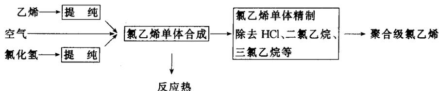
上述生产过程除单体合成属化学反应过程外,原料和反应产物的提纯、精制、分离,包括为反应过程维持一定的温度、压力而进行的加热、冷却、压缩等均为物理加工过程。据资料报道,化学与石油化学、制药等工业中,预处理、后处理物理加工过程的设备投资约占全厂设备投资的 90% 左右,由此可见它们在化工生产过程中的重要地位。
