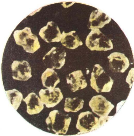
单晶刚玉是以铝矾土、黄铁矿、无烟煤和铁屑等为原料，在电弧炉内经高温冶炼而成。
