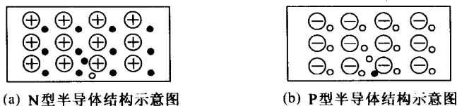
图 1.4 N 型半导体和 P 型半导体结构示意图
