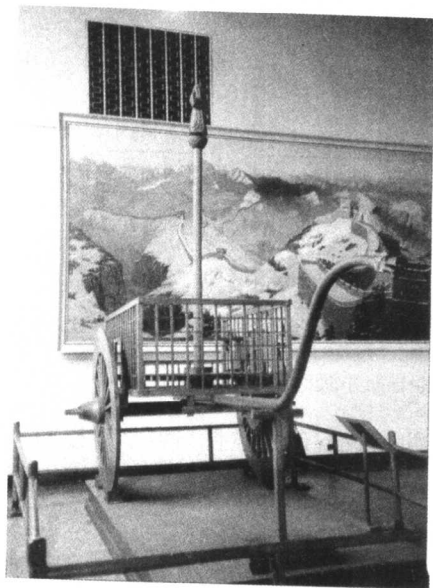
图 1.4 中国马钧研制的用齿轮传动、自动指示方向的指南车（公元 235 年）
