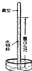
圖 1.2 用水銀柱量大气压
