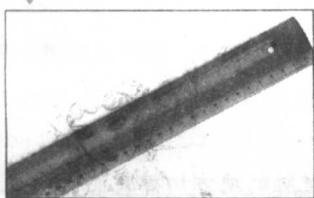
要注意的是，尺应该是透明的，尺边有沟槽或斜面的，以避免墨水流到尺和纸的中间，破坏画面，造成要修改的麻烦。
