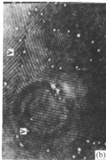
图 1-13 SiC 晶体(0001)面上近似于阿基米德式的螺旋 (a) 圆形;(b) 多角形螺旋
