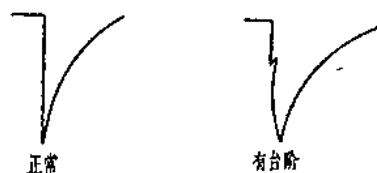
图 11 雪崩管脉冲幅度对上升时间的影响
