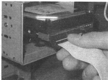
图 1-8 插上硬盘 IDE 数据线
