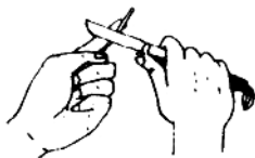
图 1.6 电工刀削绝缘皮手法
