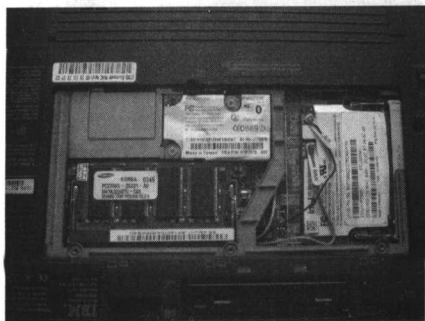
IBM X40 笔记本的可升级模块，主要有内存、蓝牙 BMDC 模块、无线网卡模块。
